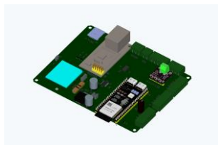
کنترلر، برد ورودی و خروجی و پنل کاربری؛ رندر فایل های STEP پروژه
